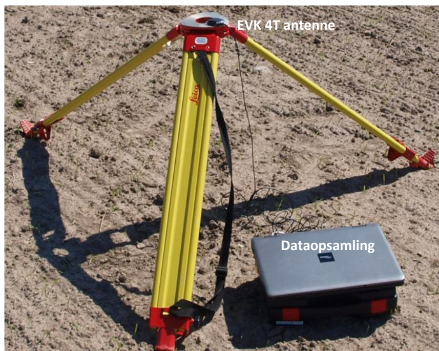
Figur 39: På ovenstående billede kan masterstationen ses. Antennen sidder på et stativ, og ledningen fører ned til en EVK-4T modtager. Opsamlingen af data kører igennem den viste computer, hvorpå der er installeret u-center.
