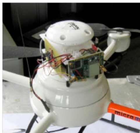
Figur 3: Den helikopter der er anvendt i forbindelse med den omtalte artikel. På denne helikopter, er der både installeret RTK-GNSS samt IMU (Rieke, et al., 2011).
