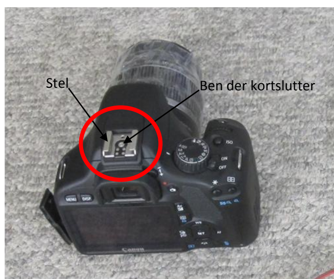
Figur 12: Markeret med rød cirkel, ses blitz-skoen som anvendes til at sende signal til u-blox modtageren.
