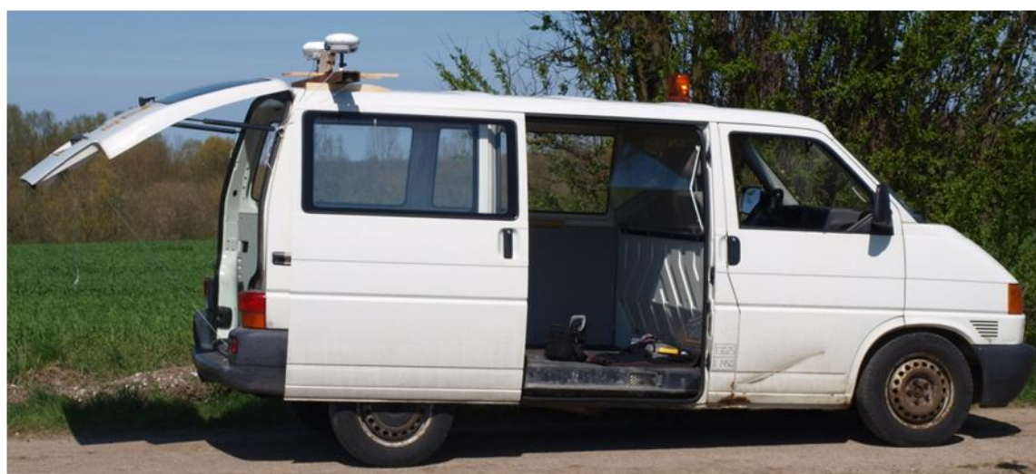
Figur 40: På dette billede kan "forsøgsopstillingen" ses. To Trimble GPS-modtagere er monteret på toppen af en bil. Mellem disse er en EVK-6T placeret.
