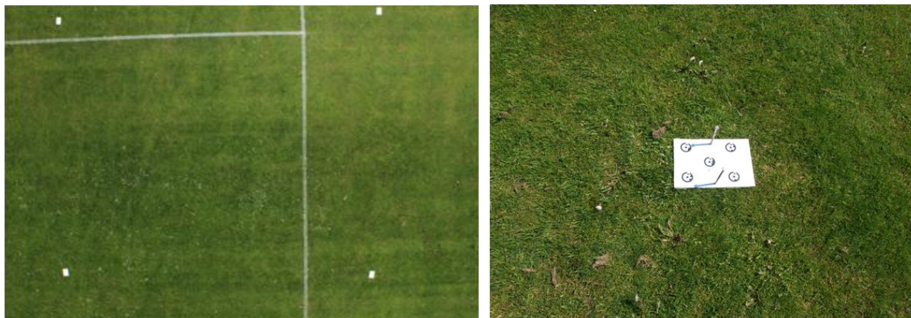
Figur 51: På det venstre billede ses de fire ark som skal anvendes ved beregning af leverarmen. På det højre billede ses ét af arkene. Her kan de fem targets ses samt de to søm som holder arket fast.
