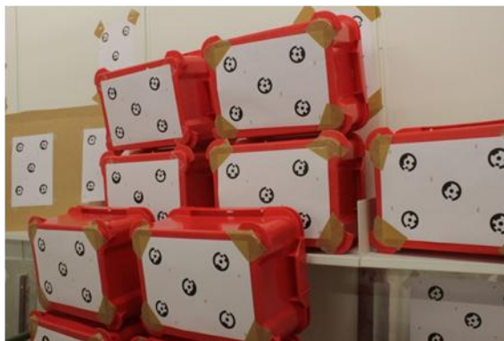
Figur 58: Placeringen af targets ved udførelse af kamerakalibreringen.
