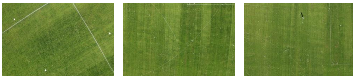
Figur 53: Eksempler på billeder optaget i forbindelse med forsøget. Første billede er optaget i ca. 15m højde, og anvendes til leverarmsberegningerne. Andet og tredje billede er optaget i 30m højde, og er fra flyvningen over testområdet.
