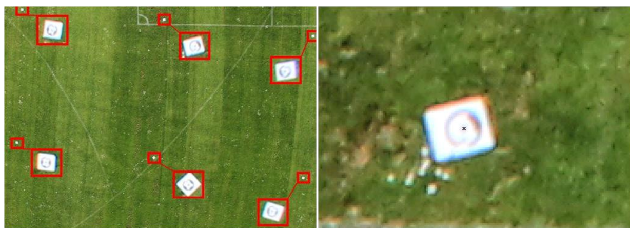
Figur 54: Udsnit af et billede optaget 30 meter over jorden. På billedet til venstre kan der ses 6 targets. Billedkvaliteten af punkterne fremgår gennem zoom-boksene. Midt i hvert target er der én sort plet, og det er denne som er koordinatgivet. Dette er illustreret på billedet til højre. Krydset markere den billedmåling der er lavet til den sort plet.
