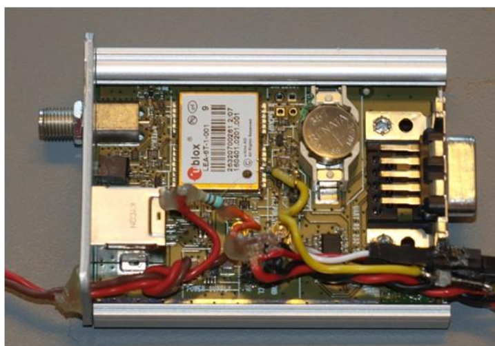
Figur 10: Det benyttede evaluation kit fra u-blox. Modtageren er blevet modificeret så det er muligt at tidsstemple samt fortage trådløs dataoverførelse via et radiolink.
