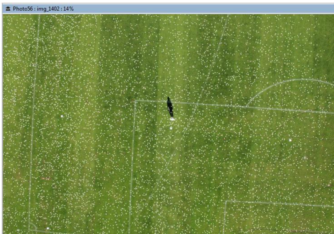
Figur 46: Et eksempel på antallet af SmartPoints som er programmet har identificeret i et enkelt billede. Efterfølgende søges disse matched med SmartPoints fra andre billeder.
