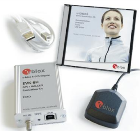
Figur 7: Delene som det anvendte evaluatuion-kit består af (u-blox 1, 2012).
