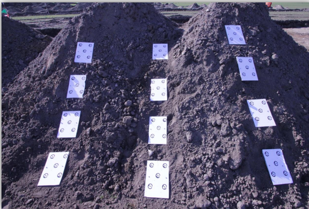
Billede 17 – Kalibreringsfelt for Ballerup-kalibrering
