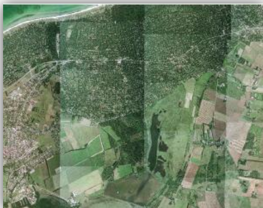
Figur 8 - Ortofotomosaik før farvejustering (Geoforum, 2005 s. 31)
