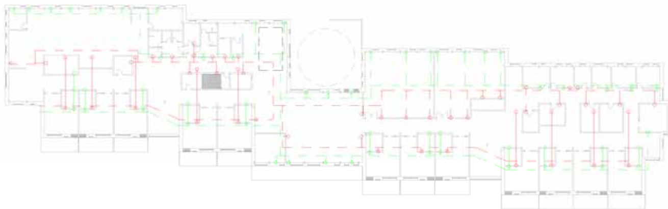
Fig. 142 Placering af armaturer. Grøn markerer indblæsning og rød udsugning. Stiplede rør kører under dækket.
