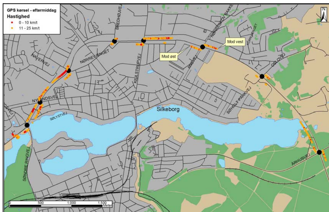
Figur 9.15 Køkørsel og kødannelse på Ringvejen i eftermiddagstrafikken. Trafikken fra øst mod vest er vist på nordsiden af Ringvejen.
