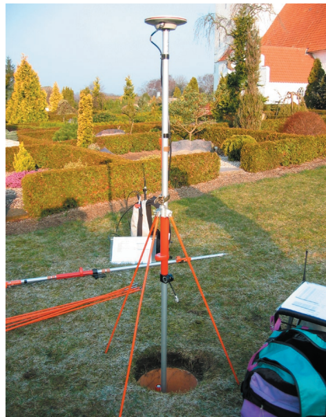
Figur 9.6: Opstilling i punkt 811 med to-meter stok ved hjælp af stativben.
