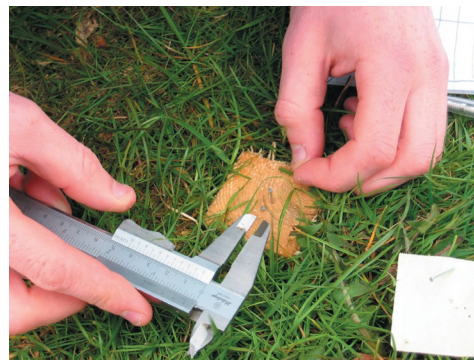
Figur 10.28: Måling af afvigelse med skydelære.
