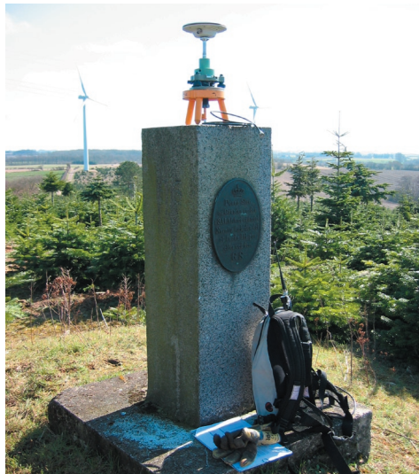
Figur 9.8: Centreringsen over punktet på postamentet ved hjælp af malleskammel.
