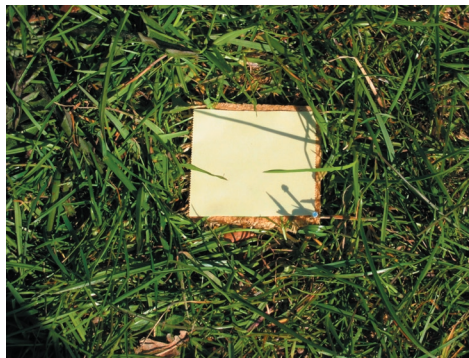
Figur 10.25: Afdækning af træpæl med tape.
