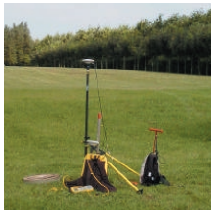
Figur 7.1: Opstilling af GPS-antenne med snapstativ. [Madsen, 2003, s. 1]
