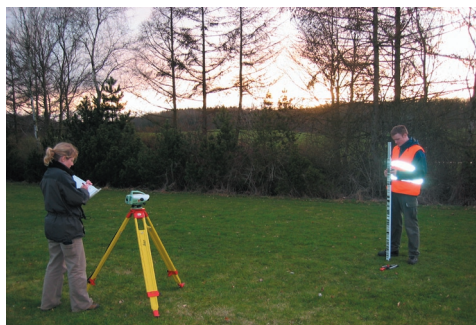
Figur 9.35: Nivellement i forbindelse med kontrolmålingen af testbanerne.
