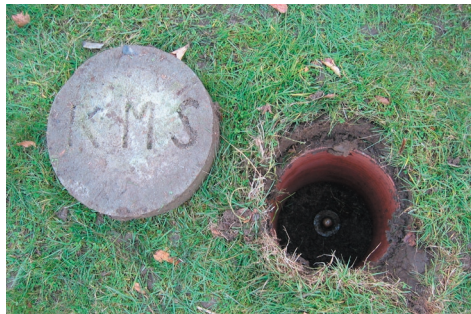
Figur 4.10: Eksempel på et 10-km punkt. Bemærk punktets placering i bunden af brønden.
