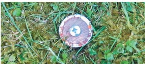
Figur 9.32: Det specialfremstillede jernrør med træ og en skrue i midten.
