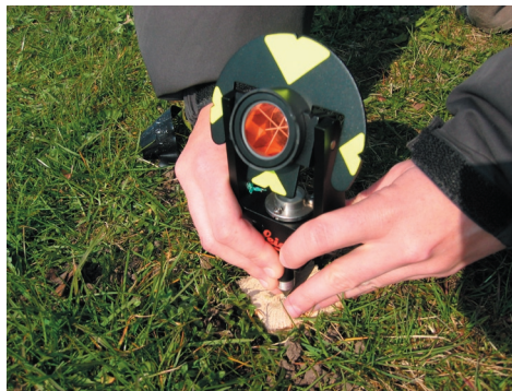
Figur 10.22: Centrerings af miniprisme over søm.
