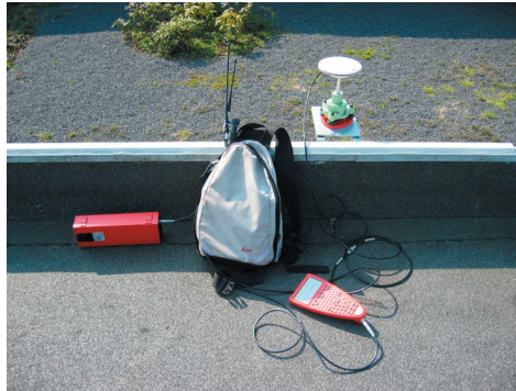
Figur 10.2: Opstilling af rover på taget af Fibigerstræde 11 i det ene af de to punkter, som er indmålt.
