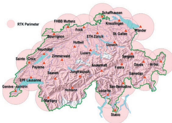
Figur 3.8: RTK-netværk i Schweiz. Systemet kaldes AGNES. [www.swisstopo.ch]
