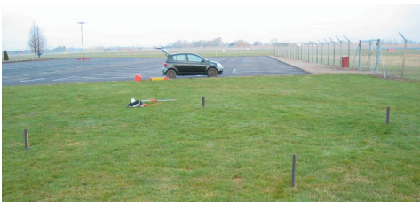
Figur 9.31: De fire jernrør inden de bliver banket ned i jordhøjde ved punkt 809.
