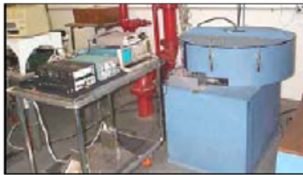
Figur 2-32: Centrifuge til kalibrering af gyroer og accelerometre. IMU'en skal ved centrifugetest monteres på kanten af rotationsfladen (Dette er den primære forskel på en centrifuge og et rate table, hvor IMU'en ved et rate table er monteret i centrum af rotationsfladen. Derfor kan en centrifuge som regel også anvendes som rate table.)
