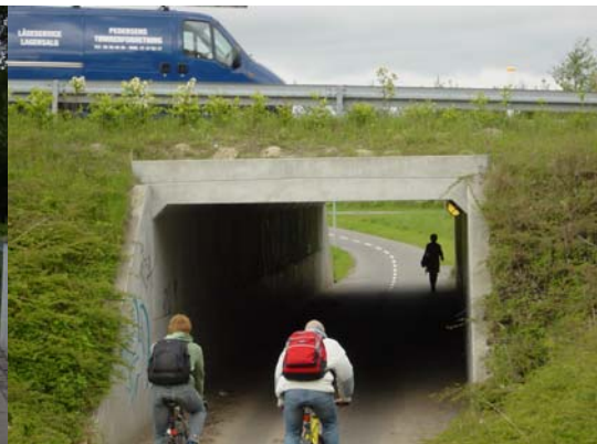
Figur 6.6. Eksempel på separation af trafik-arter. Stitunnel under stærkt trafikeret vej.
