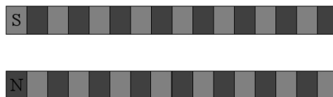
Figur 6.3: Skitse af en wiggler med flere modsatrettede poler. Partikelstrålen foretager dermed oscillationer ned igennem wiggleren og udsender dermed fremadrettet fotonstråling.
