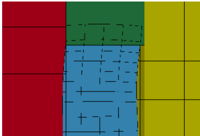
Figur 4.6: Penetrering af stempel og kerne grundet ringe stivhed i kontaktfladen.
