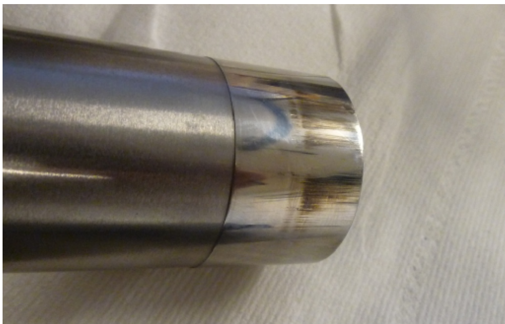
Figur 5.2: RedWolf Small HE overstempel med tydelige rivninger og varmepåvirkede zoner på siden efter 2500 producerede emner.
