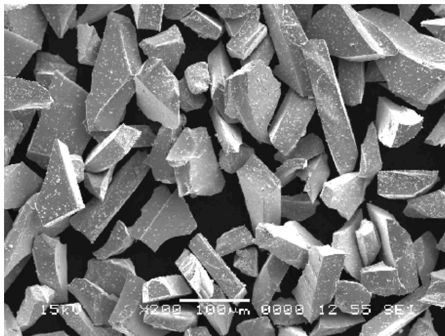
Figur 1.5: SEM-billede af IP-pulveret.
