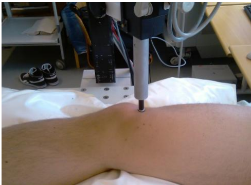
Billede 4: Viser placering af computerstyret algometer
