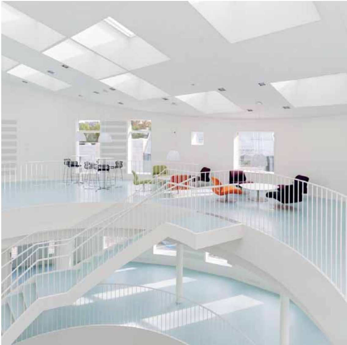
Green Lighthouse af CCO. Bygningen er organiseret omkring et indre lyst atrium, som udgør husets sociale hjerte og hvor brugen af naturlig ventilation og ovenlys, er med til at sænke energiforbruget.
