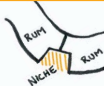
III. 194: Hvor rummene ikke kan tilpasses formen kan nicher skabes.
