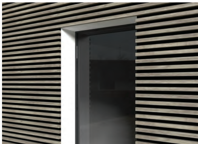
Ill. 168 - Vindue og karm tilbagetrukket
