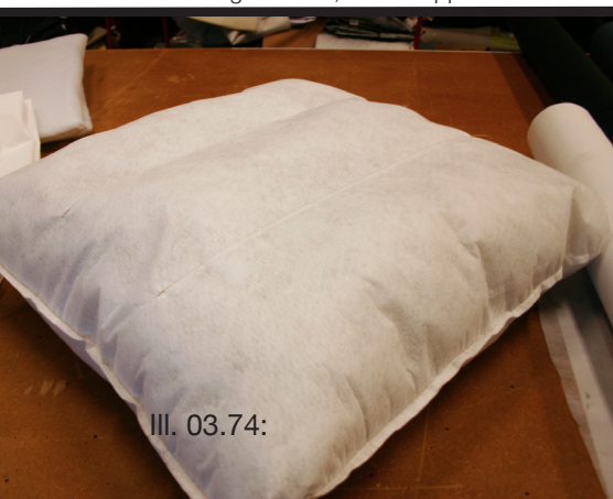
Ill. 03.72: Rygputen består af fiberkugler, som fyldes i et vliselinevår. Denne pude monteres i et fiberfillvår og vliselinevår og til sidst det endelige betræk, hvor knappen nedtrækkes i.
