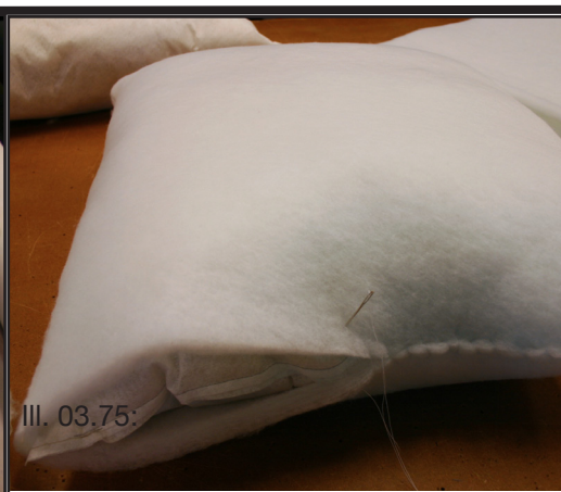
Ill. 03.72: Rygputen består af fiberkugler, som fyldes i et vliselinevår. Denne pude monteres i et fiberfillvår og vliselinevår og til sidst det endelige betræk, hvor knappen nedtrækkes i.
