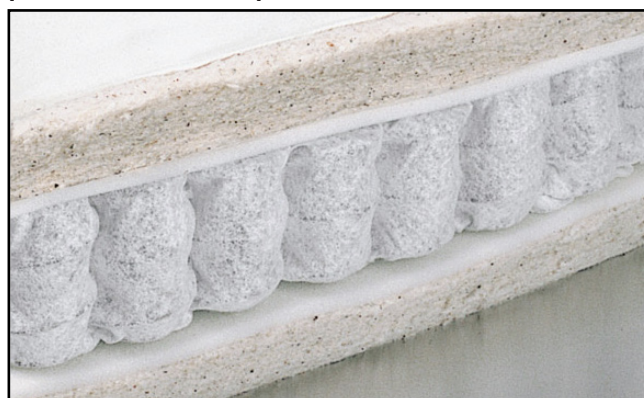
Ill. 07.34: Hebe futon: Hebe er en fusionsmadras med 6 cm posefjedre omgivet af 1 cm freonfri polyetherskum, samt 2 lag bomuld på hver side. En fjedrende luksusmadras af høj kvalitet [Innovation/madrasser.com].
