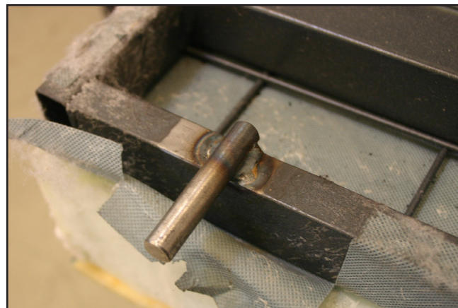
Ill. 03.32: Palen blev svejset fast på undersiden af den øverste ramme.
