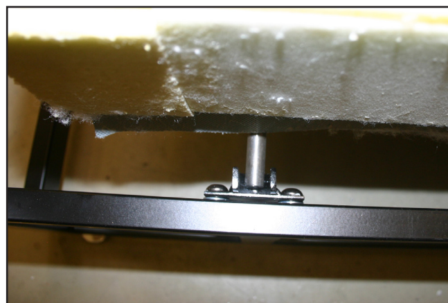
Ill. 03.33: Palen holdes fast i et beslag, som gør det muligt at løfte sæderne op og slå det nederste sæde ud.
