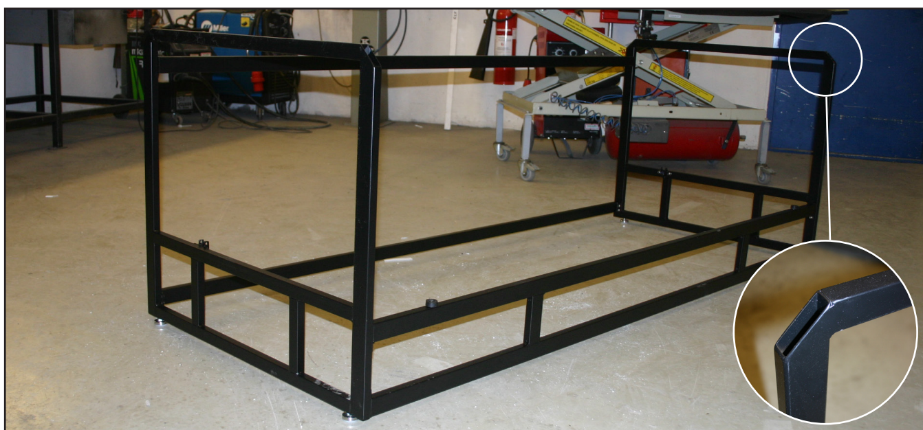
Ill. 03.57: Rammekonstruktionen blev bygget af konstruktionsstål EN 10025-2, S235JR. Efterfølgende blev rammerne pulverlakeret. Hjørnerne på armlænene blev fjernet for at undgå spidse hjørner i det polstrede armlæn.
