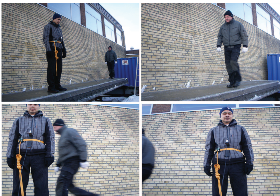
Figur 5.7: Forsøg med person, der går på dækelementet, med passiv persons tilstedeværelse.
