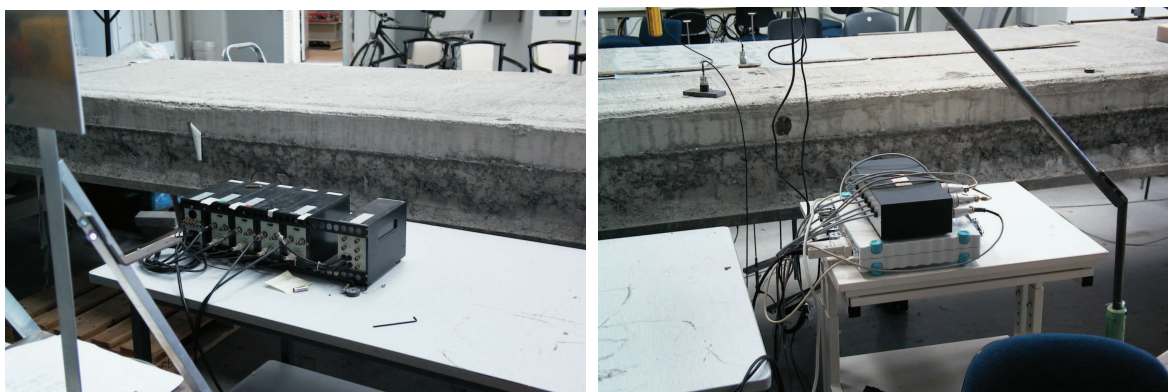
Figur 3.9: Venstre: Charge Amplifiers og Power Supply til accelerometrene. Højre: Øverst = Flytningstransducerboks. Nederst = Spider'en.
