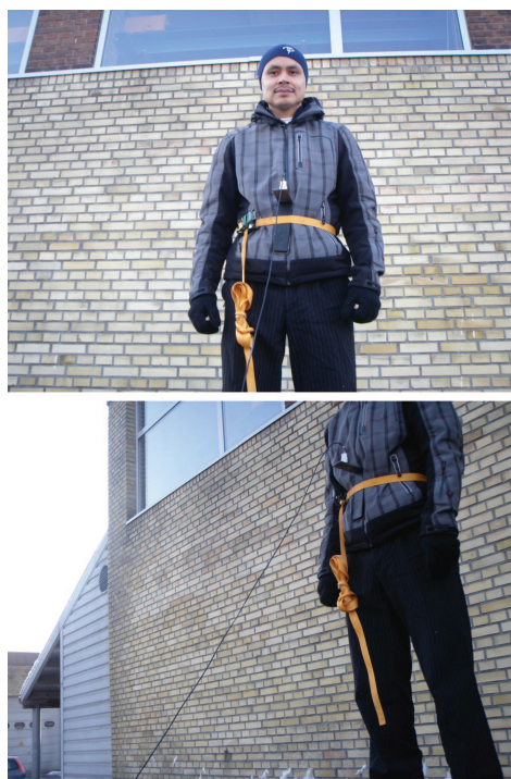
Figur 5.6: Passiv person med accelerometer monteret via vinkelbeslag og spænderem, set fra forskellige vinkler.
