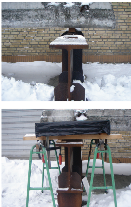
Figur 5.2: Elementets understøtninger. NB: Anordningen med bukke osv. omkring den ene understøtning, skyldes udelukkende at lette op/nedstigning for forsøgspersonerne.
