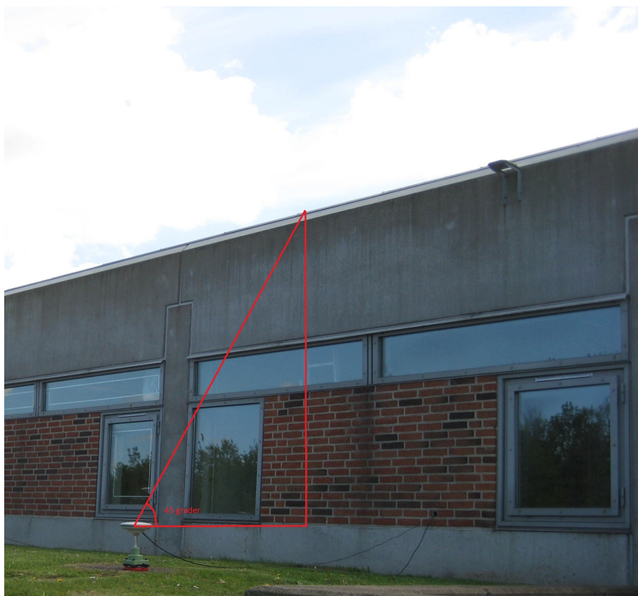
Figur 6.1: Viser hvordan en bygning danner en afskærende vinkel i 45 grader i forsøgene med forhindringer. Antennentypen på billedet er kun brugt til opsætning af dette billede.
