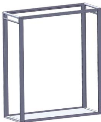
01.15. CAD-tegning af aluminiumsramme.
