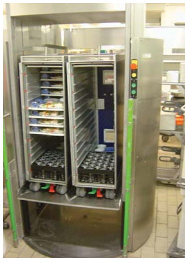
01.42. Elevator kan tilpasses i højden for at lette påfyldningsarbejdet.
