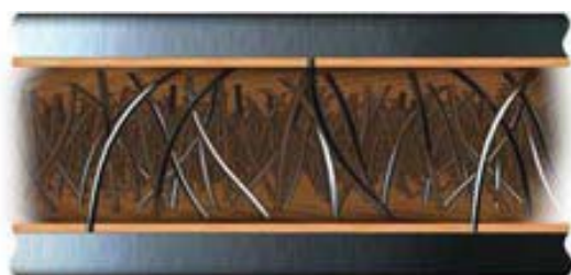
04.18. Snit igennem Alubrix , hvor man kan se de indvendige fibre.
