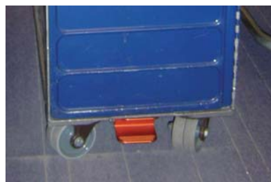
01.58. Der bremses ved at trykke pedalen ned og ved at trykke den op, med skosnuden, låses den op igen.
