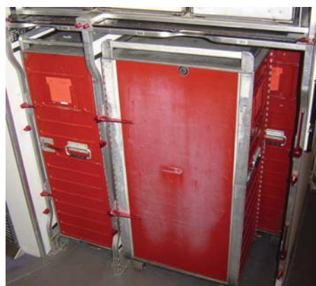
01.06. Når 2/3 trolleys fastspændes i flyenes galleys forekommer der spildplads.
