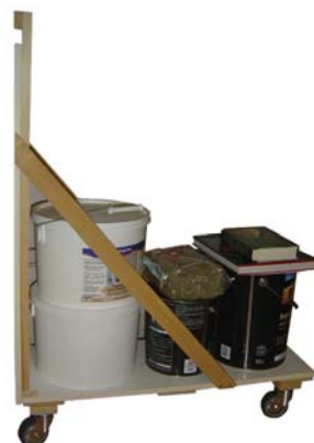
02.09. Der er tilført vægt for at simulere en fyldt trolley.
