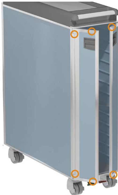
04.17. Placering af nylonbøsninger for støjreducering.
