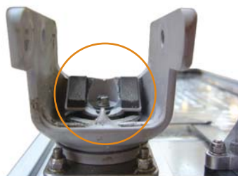
01.24. Kørselsposition - bremseklodsens er sænket.
