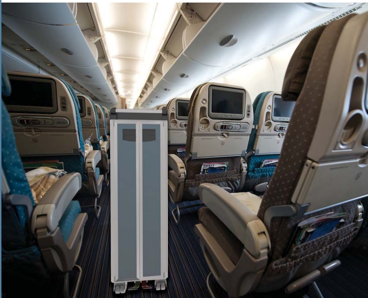
04.09. Dobbeltlågerne giver mulighed for at åbne og lukke trolleyen i gangen mellem sæderne.
