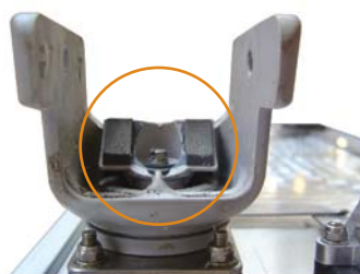
01.25. Bremseposition - bremseklodsens er hævet.
