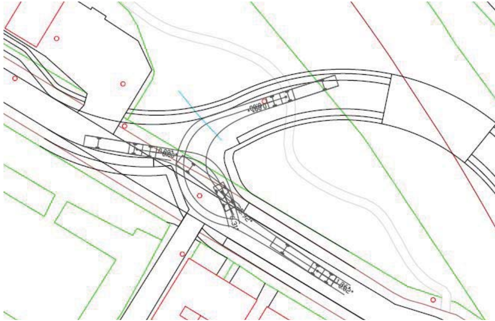
Figur 36 Arealbe- hovskurver for et sættevognstog fra den forlagte Thi- stedvej til den eksis- terende Thistedvej med exceptionelle minimumsradier
