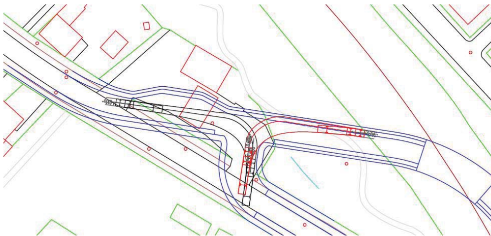
Figur 37 Arealbe- hovskurver for et sættevognstog fra den eksisterende Thistedvej til den forlagte Thistedvej med minimumsra- dier
