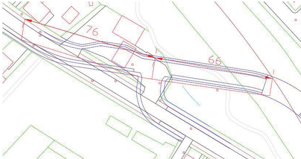
Figur 34 Oversigtsforhold ved tilslutningen af den eksisterende Thistedvej til den forlagte Thistedvej med minimumsradier
