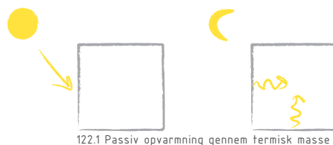
122.1 Passiv opvarmning gennem termisk masse
