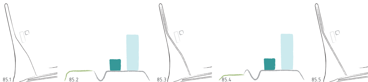
85.1-85.2 Den "tørre" side går i ét med diget, plan og snit
