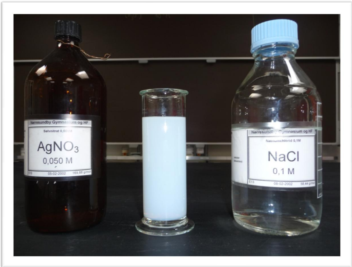
Fig.5. Et bundfald af sølvchlorid er blevet dannet ved at sammenblende \text{NaCl}(\text{aq}) og \text{AgNO}_3(\text{aq}) i et cylinderglas
