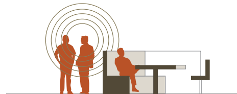
ill. 55: Diagram der viser hvordan støjgener fra for-bipasserende undgås i køkkenet ved indarbejdelse af skærmvægge.
