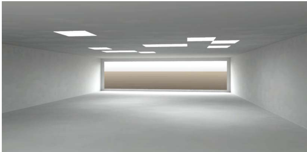
ill. 35-36: Andet lysforsøg Undersøgelse af hvilken effekt 10 m 2 ovenlysene har på luxniveauet. Gennemsnitslig luxniveau: 769 lux Energiforbrug: 37,7 kwh/m 2
