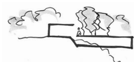
ill. 22-23: Dele af bygningen nedgravet i skrænten for at mindske aftrykket på sitet.
