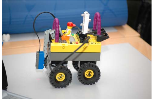
Figur 1 RCX brikken, der er bygget til en kørende robot.
