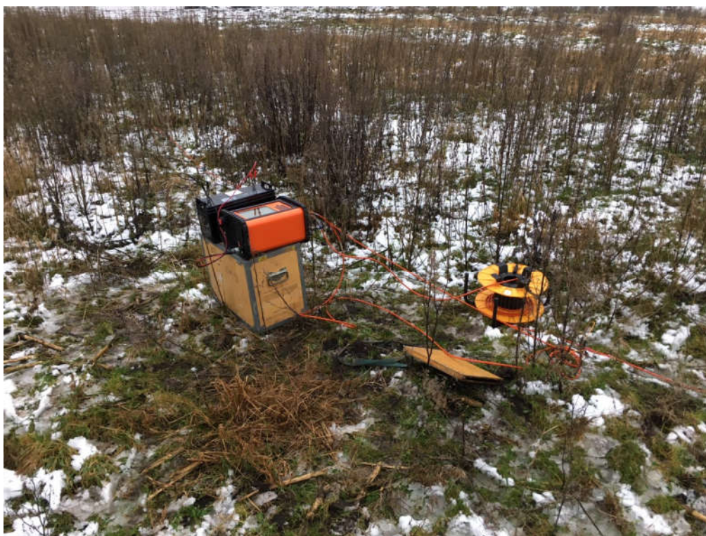
Figur 21 MEP-station med terrameter tilsluttet eksternt batteri til venstre, og til højre kabeltromle
