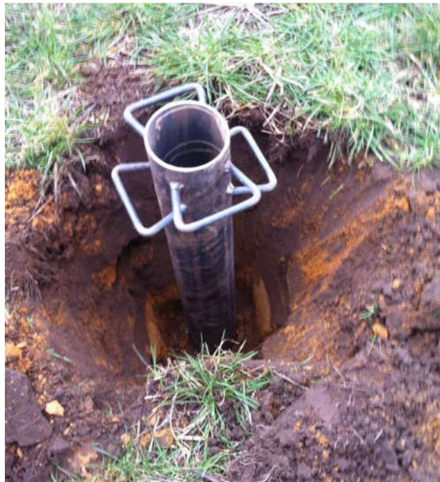
Figur 27 Billede af hydraulisk ledningsevne forsøg
