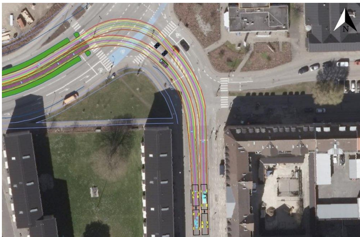
Figur 17: Arealbehov for en 21 meter enkeltledet bus' svingmanøvre fra Karolinelundsvej ned ad Bornholmsgade. Ortofoto er fra 2017.
