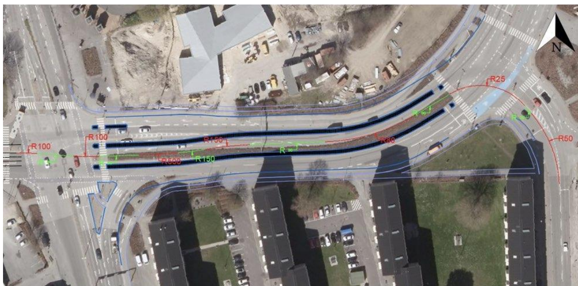
Figur 24: Horisontalradier for +Bussens tracé på Karolinelundsvej. Ortofoto er fra 2017.
