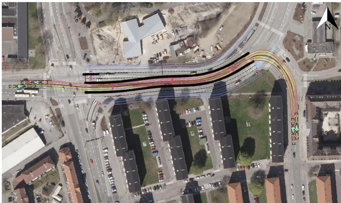
Figur 13: Skitseprojektering af +Bussens delstrækning på Karolinelundsvej inkl. kørekurve for en dobbeltledet bus. Ortofoto er fra 2017.
