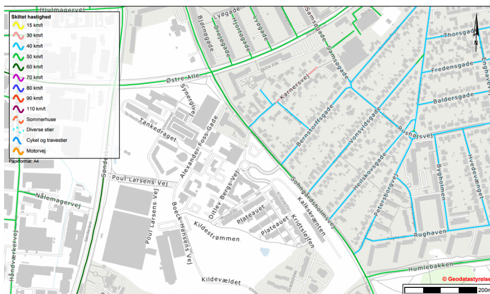
Figur 3.2. De skilte hastigheder på strækningerne.
