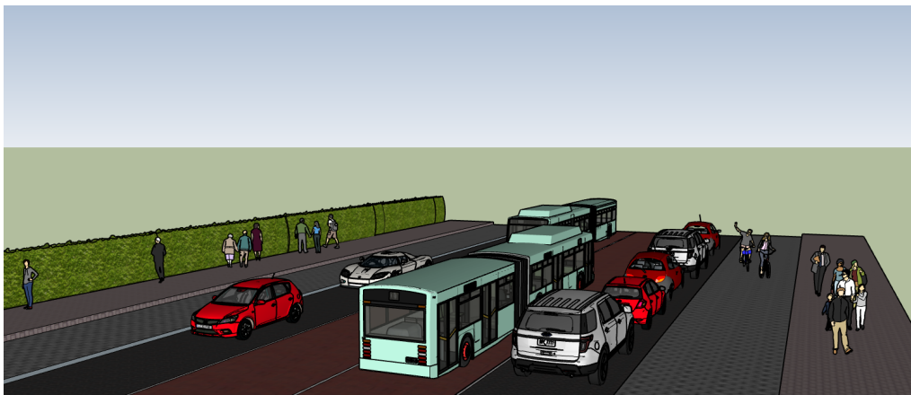
Figur 3.18. Principskitse af systemets opbygning med prioriteret busbane
