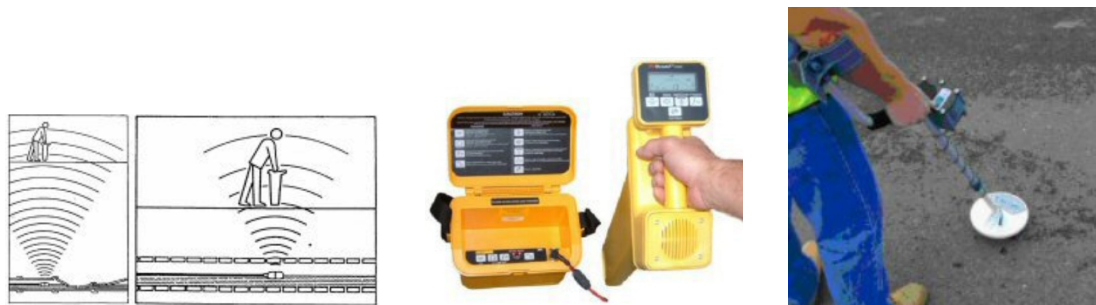
Figur 2.2. Yderst til venstre er vist en sondelokalisering, i midten er vist udstyret til en elektrisk lokalisering, og yderst til venstre er vist en dækselsøgning. [Teknologisk Institut, 2017]
