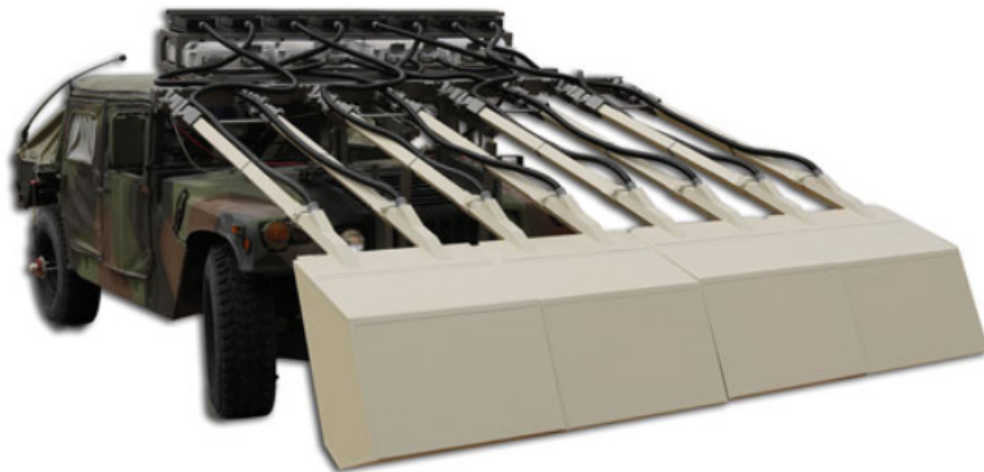
Figur 3.2. Eksempel på produktet monteret på en militærbil [IDS, Ingegneria Dei Sistemi, 2017b].
