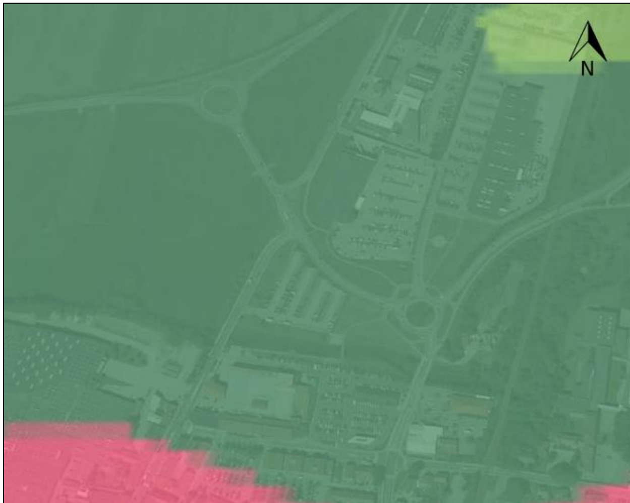
Figur 5.7 Geotekniske forhold for området ved krydset. Mørkegrøn markerer marsk, lysegrøn ferskvandsdannelser, lyserød smeltevandssand og -grus.
