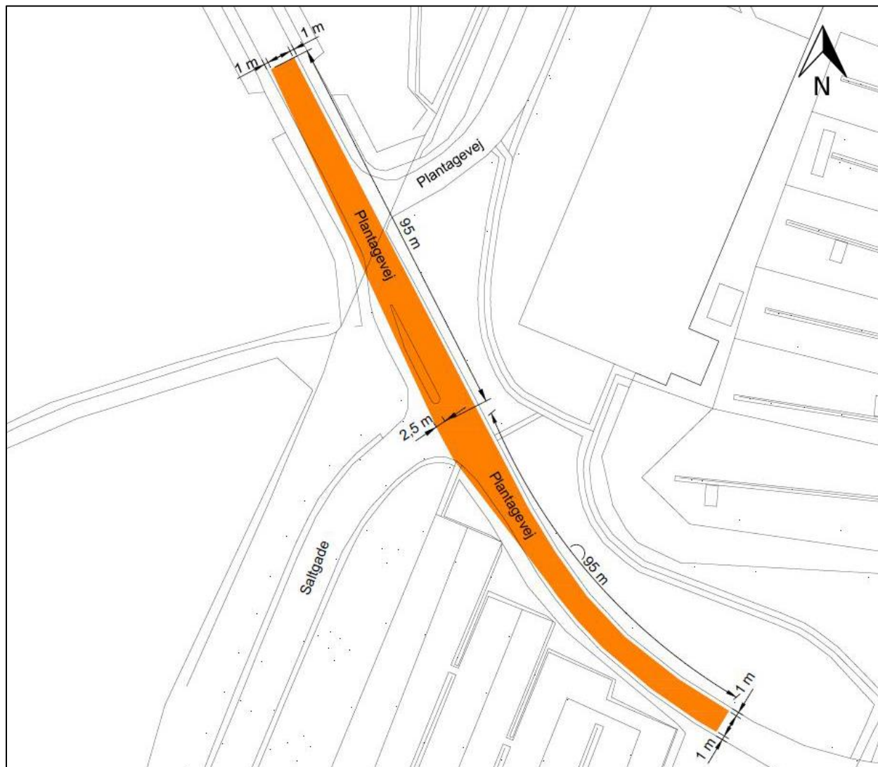
Figur 5.12 Oversigtsarealer for det eksisterende kryds markeret med orange.
