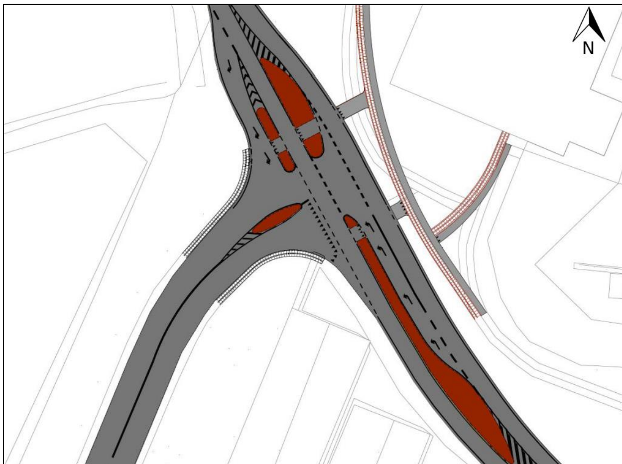
Figur 9.4 Udklip af belægningsplan for krydset, hvoraf krydsets udformning fremgår.
