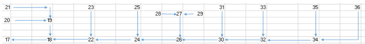
Figur 8.3: Punkterne hvor tryktabet er beregnet ved udsugning.
