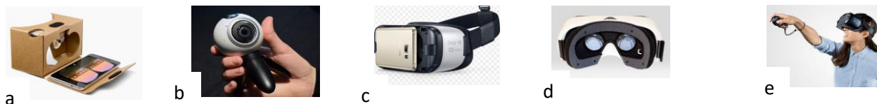
Billede 1: I afhandlingen anvendes Cardboard (a), VR-teknologien "Samsung VR-gear set", der består af en 360° kugleformet videokamera (b), HMD (c), en kompatibel Samsung Galaxy smartphone (d), evt. VR-kontroller (e), stativ til kameraet.
