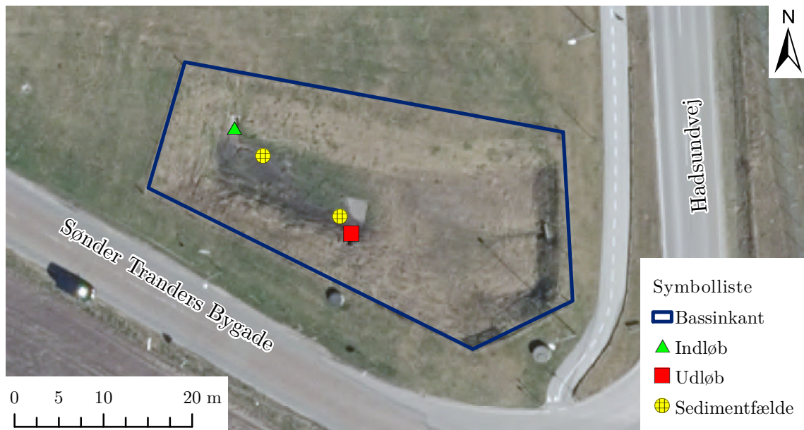
Figur F.2: Placering af sedimentfælder i regnvandsbassinet ift. indløb og udløb.
