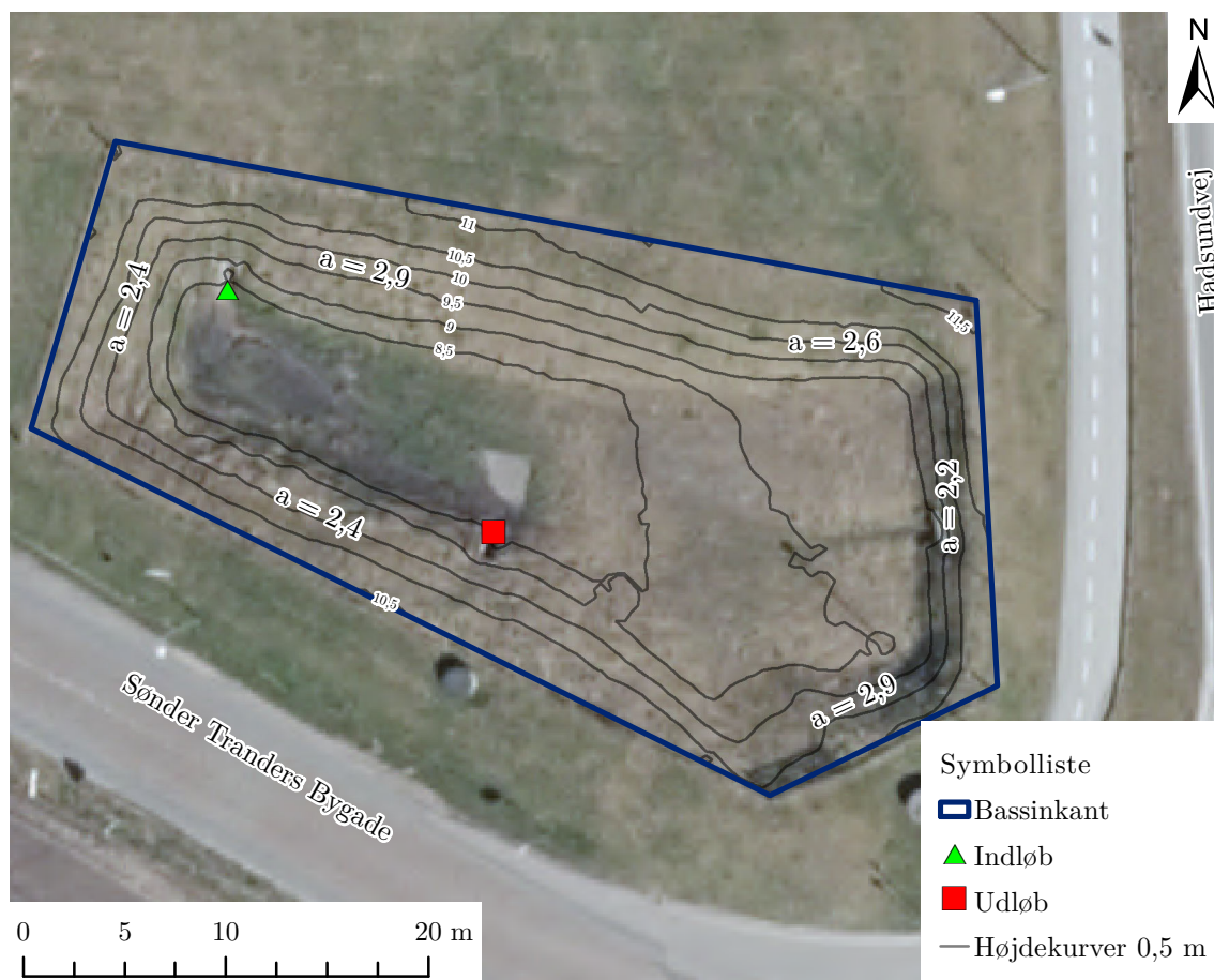
Figur 4.2: Regnvandsbassin i projektområdet med placering af indløb, udløb og bassinkant. Højdekurver og anlæg på siderne er estimeret på baggrund af en højdemodel fra Kortforsyningen [2016].
