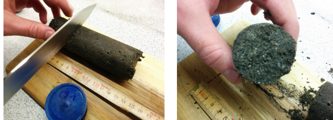
Figur D.6: Deling af intaktprøver med kniv og et tværsnit efter delingen.
