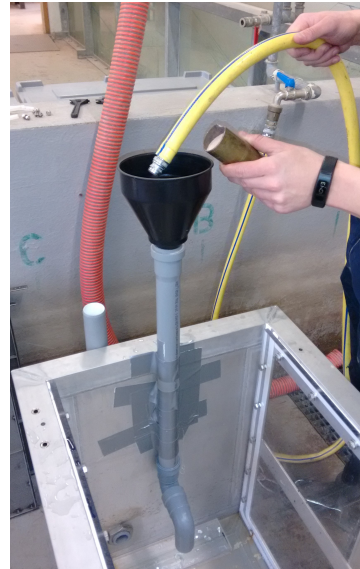
Figur 8.7: Udformning af indløb, samt metoden hvorpå vand og sand tilføres forsøgsbassinet.
