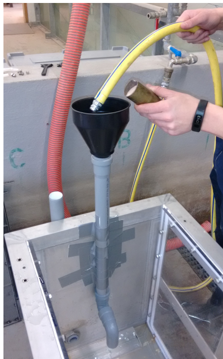
Figur N.2: Udformning af indløb, samt metoden hvorpå vand og sand tilføres forsøgsbassinet.
