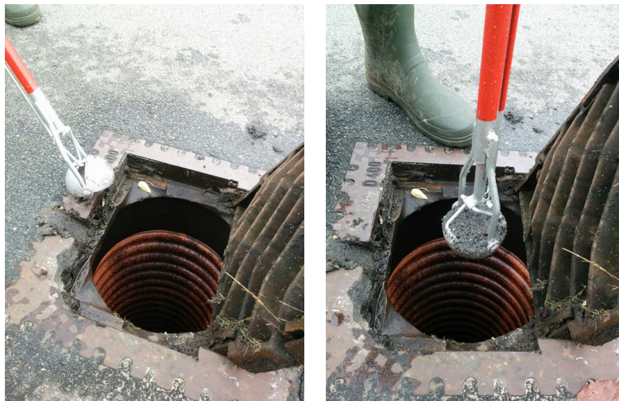
Figur D.3: Indsamling af poseprøver med kloakskovl.
