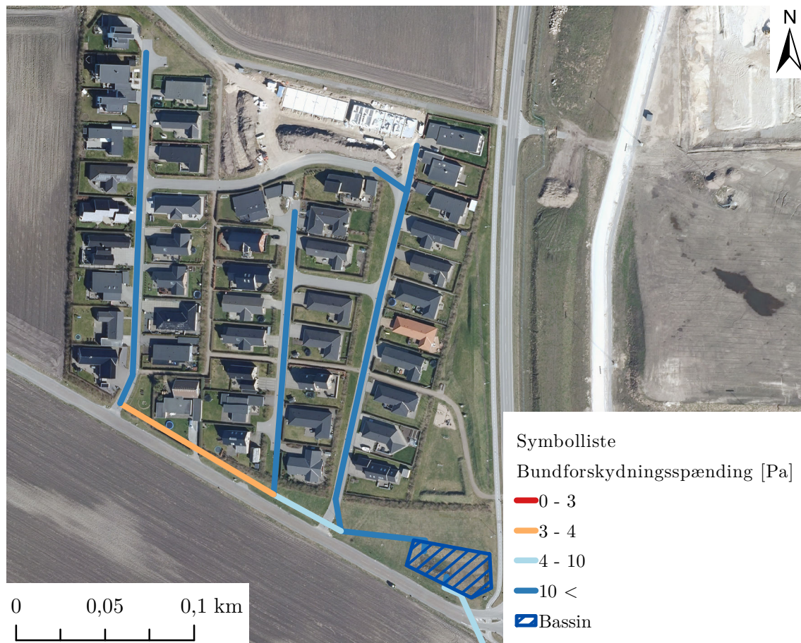
Figur 5.17: Bundforskydningsspændingen i afløbssystemet.
