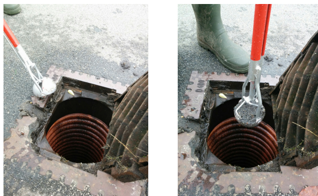
Figur 5.3: Indsamling af poseprøver med kloakskovl.
