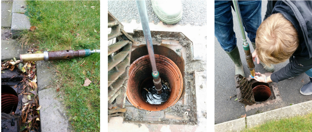
Figur D.2: Intaktprøveudtagning.
