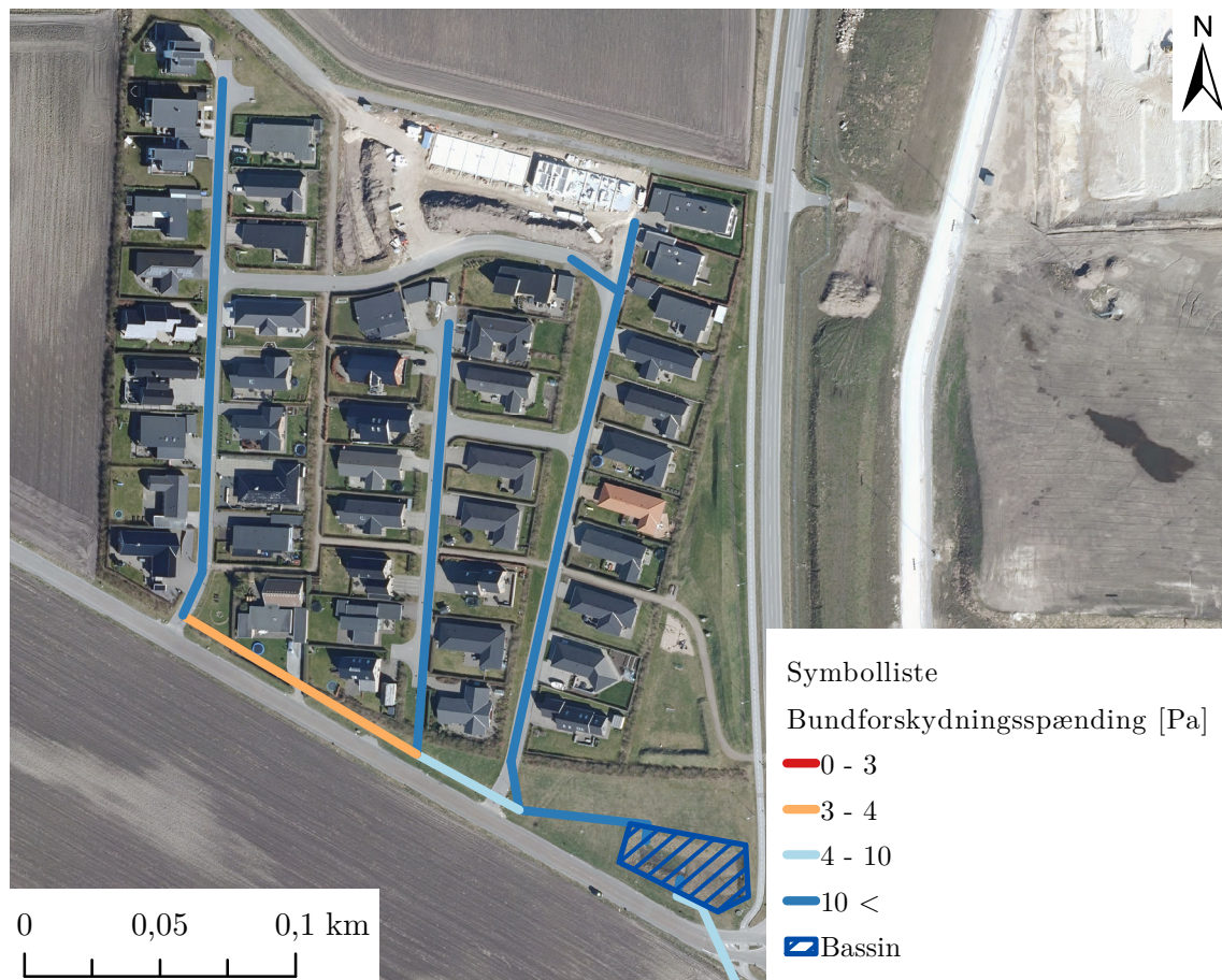
Figur G.1: Bundforskydningsspændingen i afløbssystemet.
