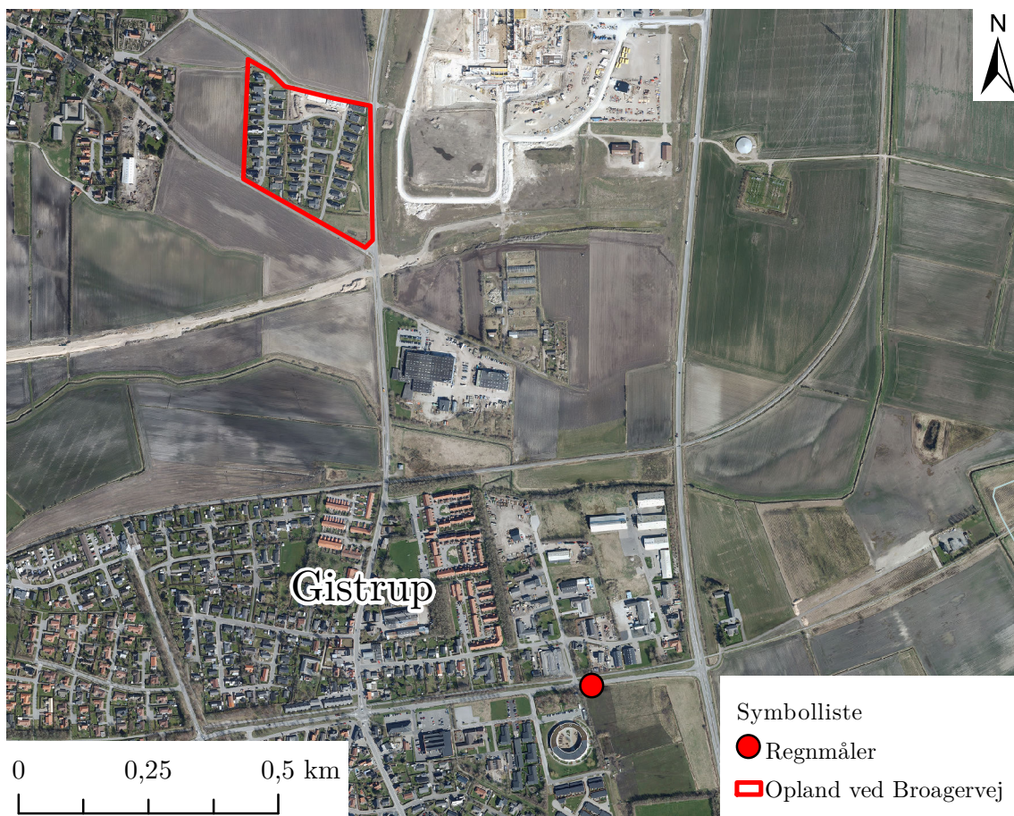
Figur C.1: Placering af den anvendte regnmåler ift. projektoplandet.
