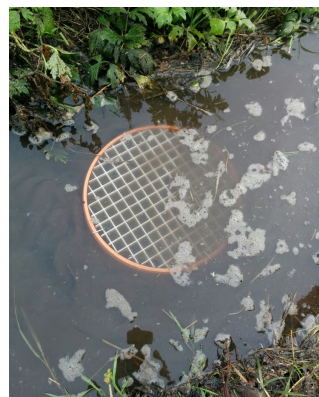
(b) Nedgravet sedimentfælde.
