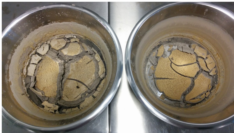
Figur F.5: Oventørret sediment fra bassin i kraftig aggregatdannelse.
