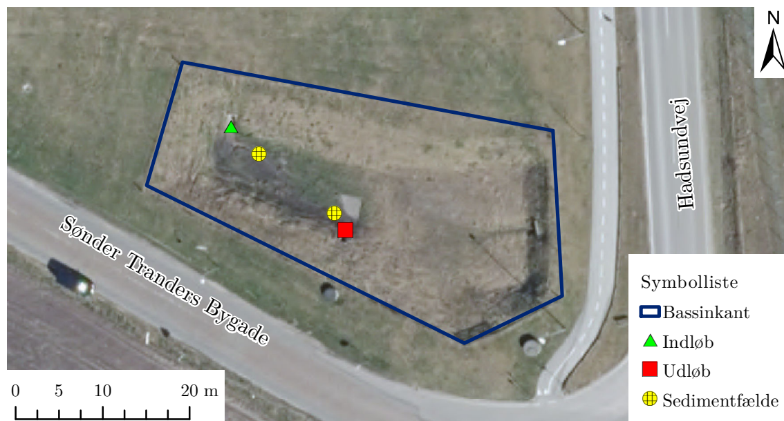
Figur 5.11: Placering af sedimentfælder i regnvandsbassinet.
