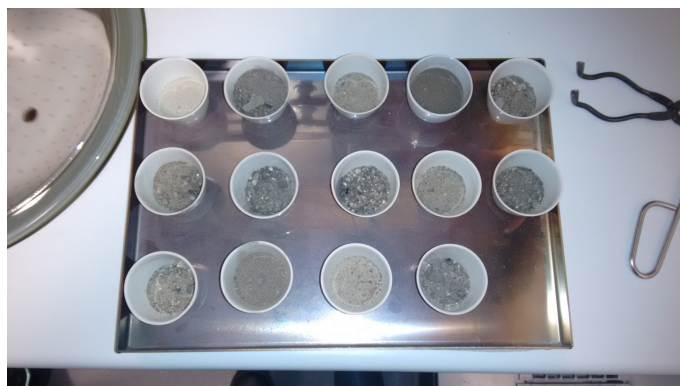
Figur D.16: Placering af digler på bakke til glødeovnen.
