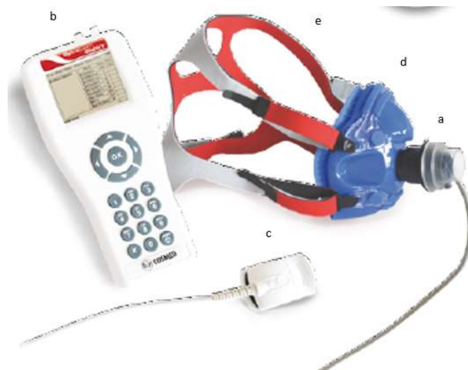
Figur 5. Spiropalm med turbine(a), monitorenhed (b), pulsoxymeter (c), maske (d) og headset (e). Cosmed Italy, 2015
