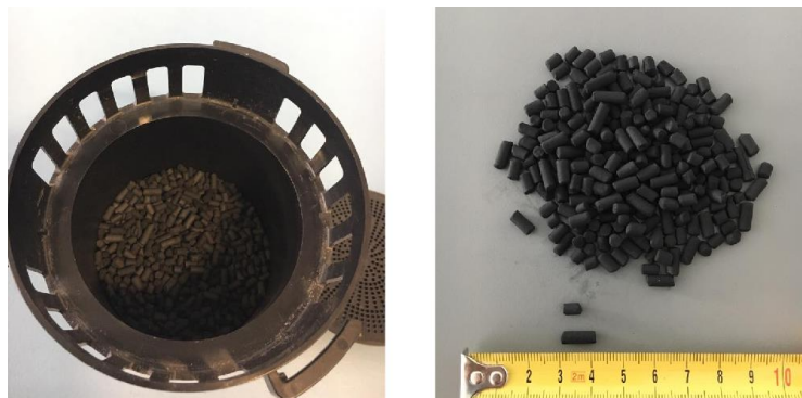
Figur 2.7. Til venstre ses kulpiller placeret i filtercylinderen. Til højre ses aktive kulpiller til Hybrid Mini Kulfiltret.
