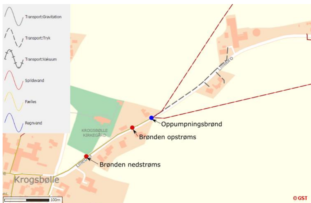
Figur B6.2. Placering af oppumpningsbrønd, samt brønden opstrøms og nedstrøms hvori der foretages feltmålinger (Nordfyns Kommune, 2017).
