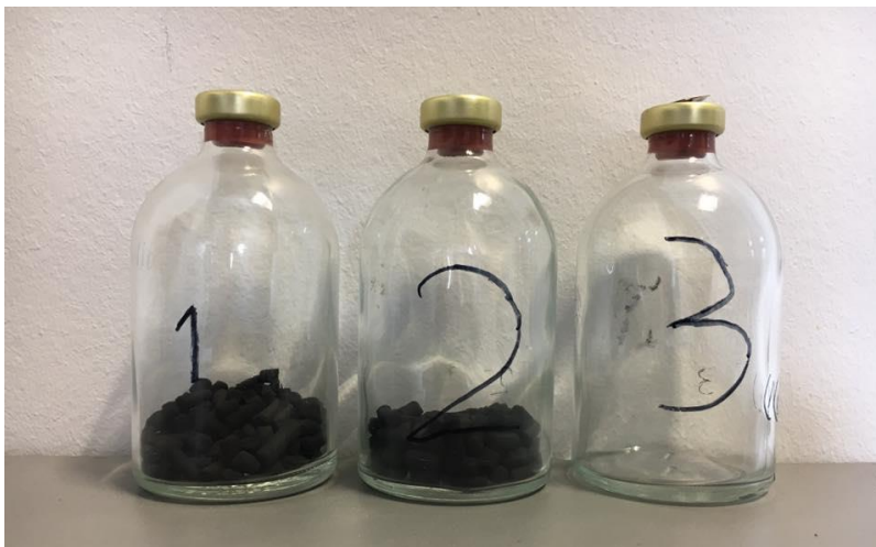
Figur 3.13. Serumflasker der bruges til at undersøge metanfjernelse af filtermaterialer fra Hybrid Mini Kulfiltre.
