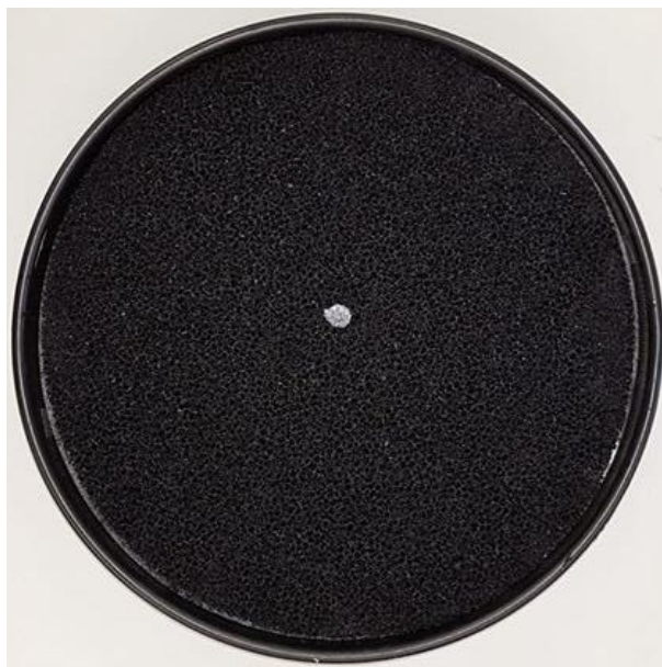
Figur 4.26. Hybrid Brøndkarmsfilter brugt til forsøg med filterhastighed.
