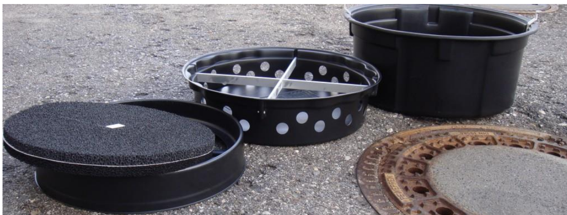
Figur 2.1. Foto af et Hybrid Brøndkarmsfilters fire delelementer (Fritzmeier Umweltechnik, 2017).
