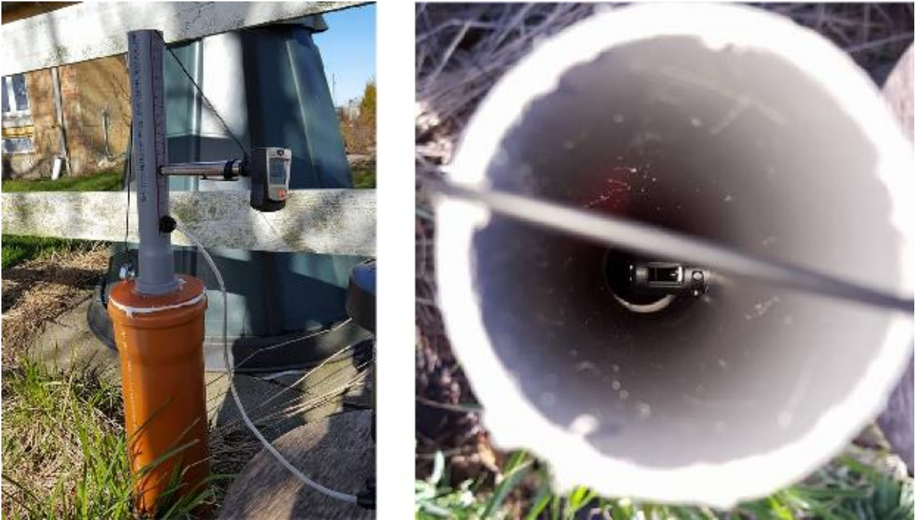
Figur 3.16. Til venstre, \varnothing 40 mm rør monteret ovenpå udluftningsrøret fra septiktank, samt placering af hot-wire anemometer og slange tilkoblet LI-820 CO 2 Gas Analyzer. Til højre, spidsen af hot-wire anemometeret ses midt i \varnothing 40 mm røret, og med hot-wiren vinkelret på den forventede luftstrømningsretning.
