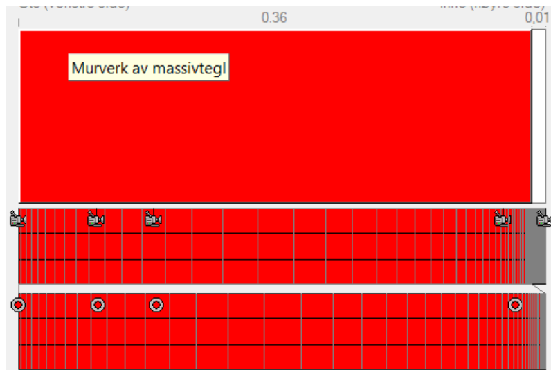
Figur 29. Angivelse af monitors placering i en given konstruktion. Monitors afføder et grafisk billede som ses i Figur 28.
