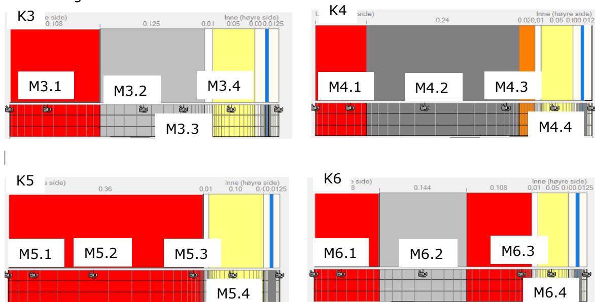
Figur 35. Opbygning af de 4 efterisolerede konstruktioner i WUFI Light, inkl. de enkelte målepunkter
