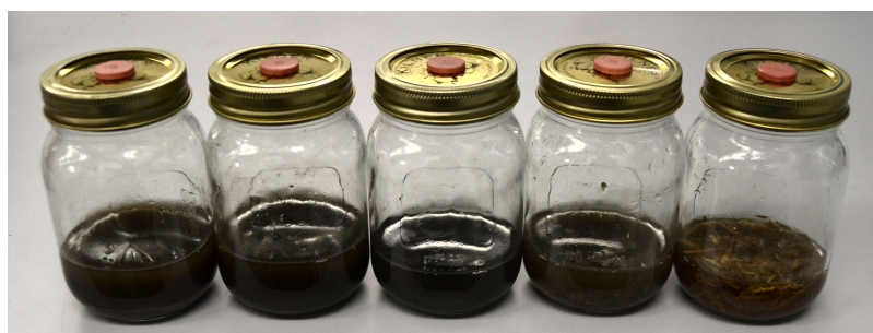
Figur 4.12: 3 mL sand, topjord, kul, savsmuld og halm indsamlet fra Torsted Sø, og 60 mL søvand i syltetøjsglas med septum til måling af DNP ved acetylen inhiberingsmetoden.
