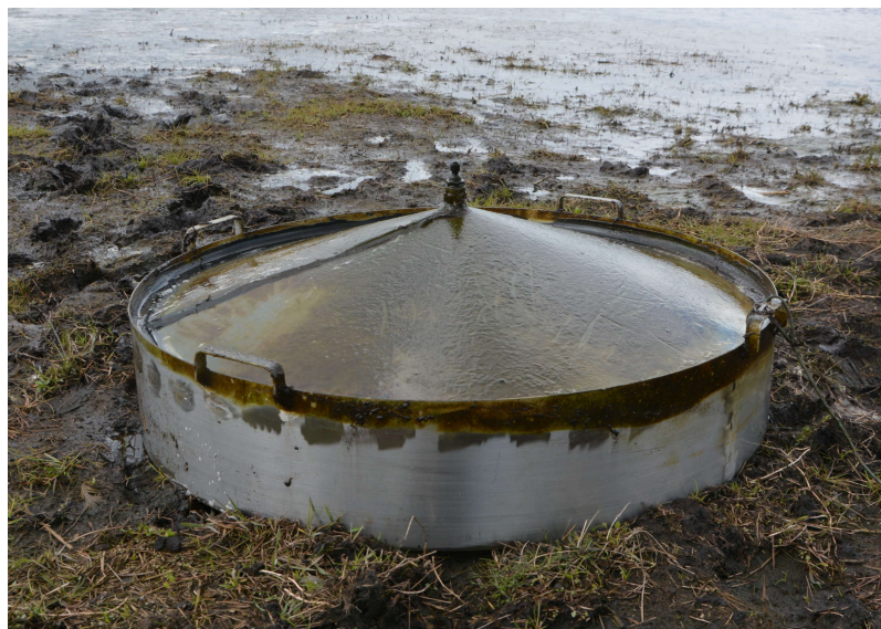
Figur 4.6: Seepage meter, der lige er taget op af søen. Algevæksten på stålringen viser hvortil seepage meteret har været skubbet ned i sedimentet. En plastikpose monteres på studsene, for at måle grundvandsindstrømningen fra arealet under seepage meteret.
