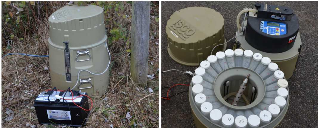
Figur 4.3: ISCO autosampler til kontinuerlig indsamling af vandprøver. Den blå slange fører ned til Torsted bæk. De to autosamlere er placeret opstrøms og nedstrøms for vådområdet.
