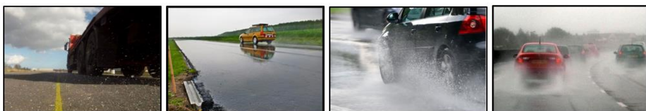
Figur 1.7: viser blow-off, run-off, splash-off og spray-off i nævnte rækkefølge (Eram b, ukendt årstal)
