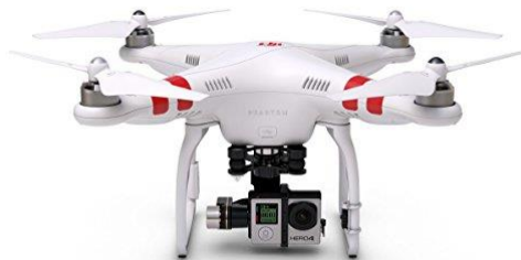
Figur 2: DJI Phantom 2 med påmonteret GoPro Hero 4. Billede fra (Dronesolo, u.d.).
