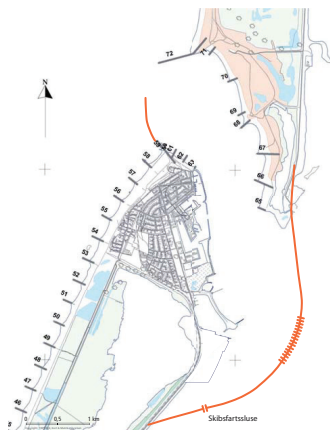
Figur 2.2. Dæmning med gennemstrømningskluse. Ingvarsdén et al. [2012]
