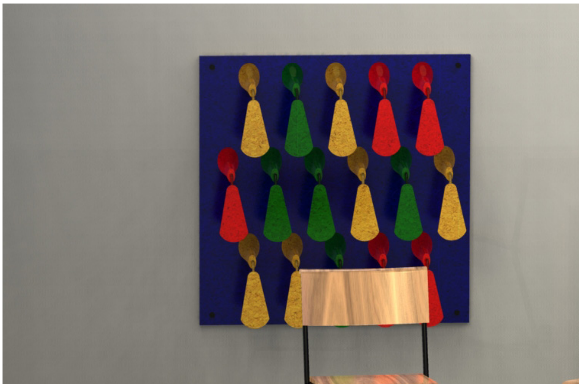
Figur 23: Viser en visualisering af opladeren som er placeret på væggen i en højde hvor børnene selv kan gå hend og sætte deres lampe i oplader og hente den igen. Opladeren har trådløs opladning, så det er så sikkert for børnene som muligt.
