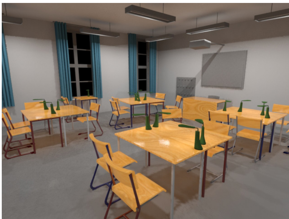
Figur 24: Visualiseringen øverst viser klasselokalets belysning som det er i dag, hvor et helt monotomt og jævnt lys er fordelt i hele lokalet. På visualiseringen i bunden kan det ses på bordene hvordan lamperne skaber et mere varieret lysmiljø med sin direkte belysning.
