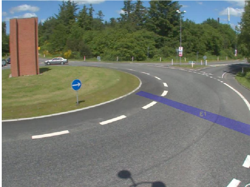
Figur A.A.1: Opstilling af detektorer til optælling af køretøjer i RUBA for projektlokalitet 1 ved efteroptagelserne.
