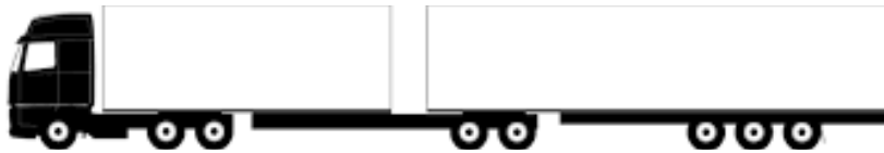
Type 3: Sættevognstrækker med link-trailer og almindelig sættevogn.
