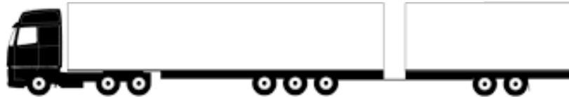
Type 2: Sættevognstrækker med almindelig sættevogn og kærre.
