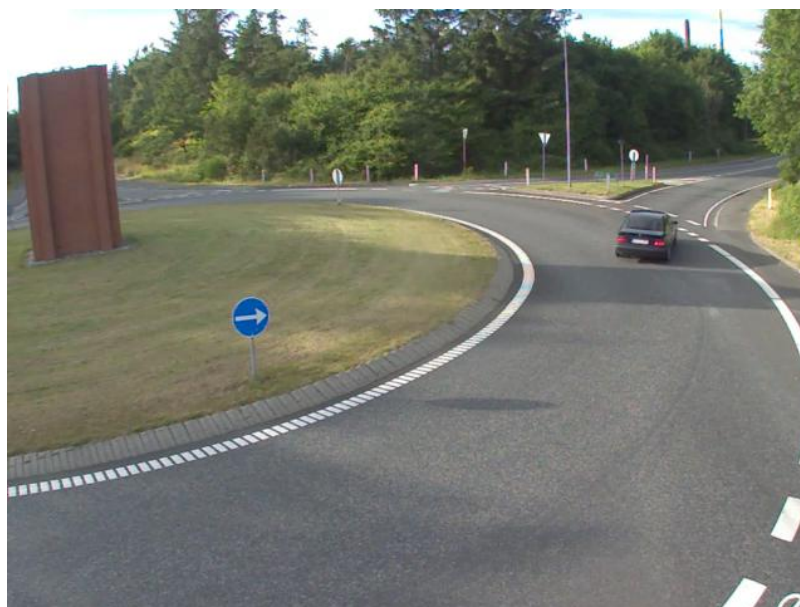
Figur 6.1: Manglende detektering af køretøj i RUBA, fordi at detektoren påvirkes af skygger.
