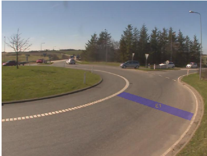
Figur 4.20: Anvendt opstilling til optælling af køretøjer i RUBA.
