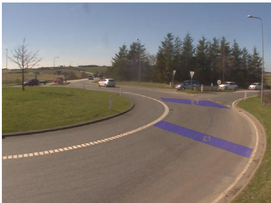
Figur A.B.2: Opstilling af detektorer til hastighedsanalyse i RUBA for projektlokalitet 2.
