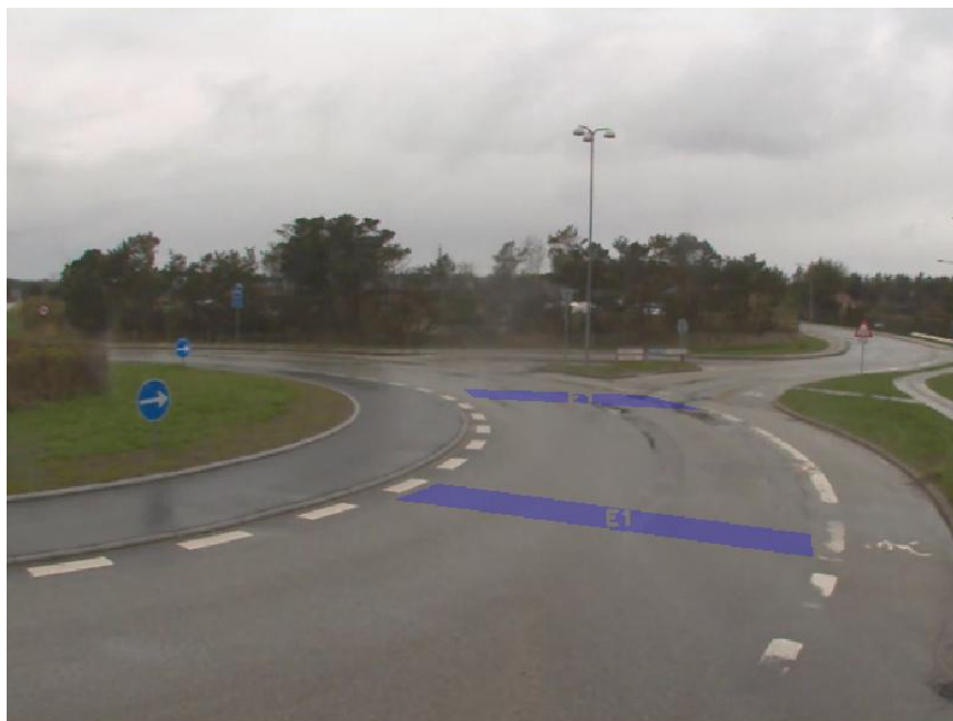
Figur A.B.3: Opstilling af detektorer til hastighedsanalyse i RUBA for projektlokalitet 3.
