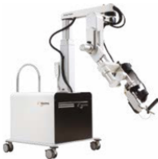
Billede 2: ArmeoPower. Baseret på både robot og exoskeleton, med seks aktiverede frihedsgrader (Hocoma n.d.).
