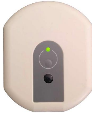
Figur 6 En stuesensor i IntelligentCARE by ANYgroup. Det grønne LED lys indikerer at sensoren er forbundet til gateway (ved fejl lyser denne rødt). Den grå knap er betjeningsknappen til testfunktioner. Det mørke område er PIR sensoren. (96)
