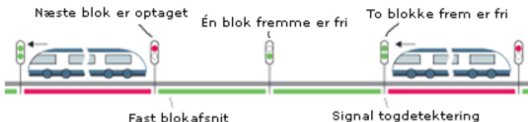
Figur 5.1: Illustration af blokafsnit og signalanlæg (Banedanmark 2008a).
