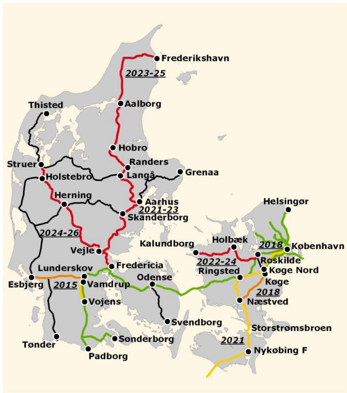
Figur 4.3: Kort over planlagt udrulning af elektrificering af jernbanenettet, røde er ikke på begyndt, grøn elektrificeret, gul og orange er undevejs.(Socialdemokraterne et al. 2014b).
