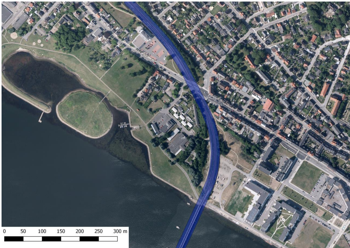
Figur 9.5: Billede der illustrerer, hvilke konsekvenser en dobbeltsporet forbindelse mellem Aalborg Vestby og Lindholm ved en bufferzone på seks meter fra profilmidten.
