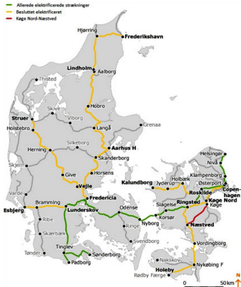
Figur 5.4: Overblik over elektrificerede strækninger og fremtidige strækninger der skal elektrificeres (Banedanmark 2014b).
