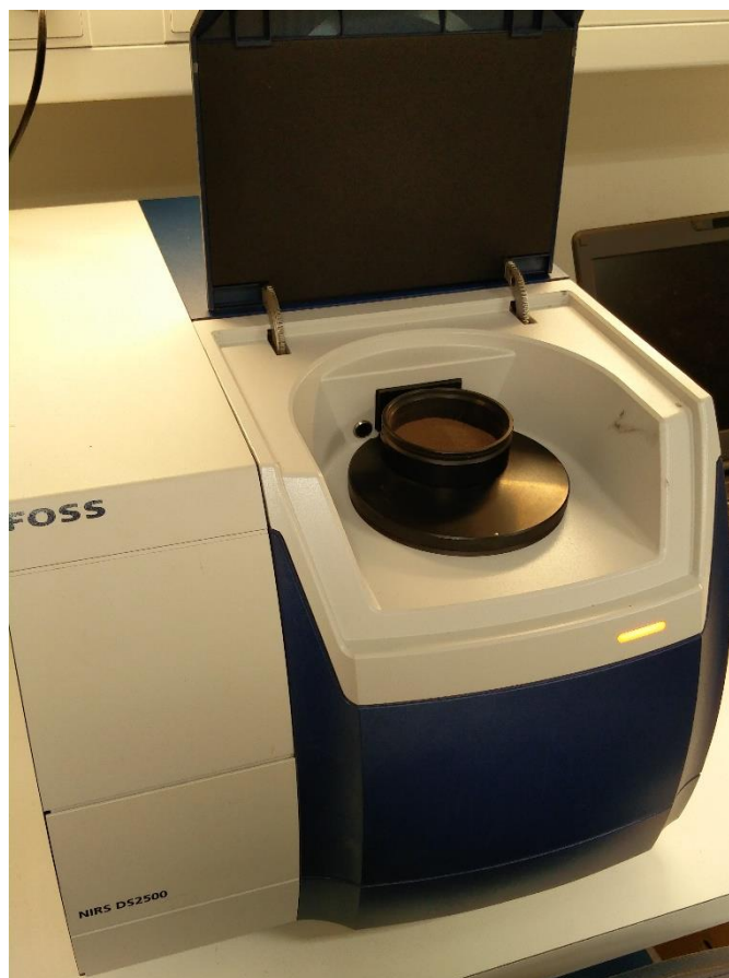
Figur 9 - Billede af NIRSTM DS2500 spektrofotometer (FOSS, Hillerød, Danmark).
