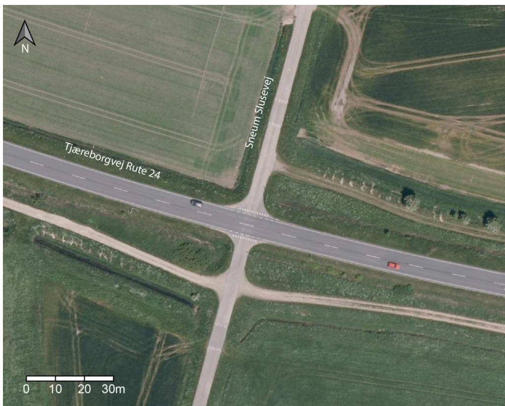
FIGUR 5.14 VIGEPLIGTSTILSLUTNING VED SNEUM SLUSEVEJ, KMT 11/0415 (VEJMAN, 2014)
