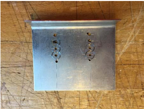
Billede 5: Skabelon til afmærkning af målepunkter så der sikres den samme afstand mellem elektroder
