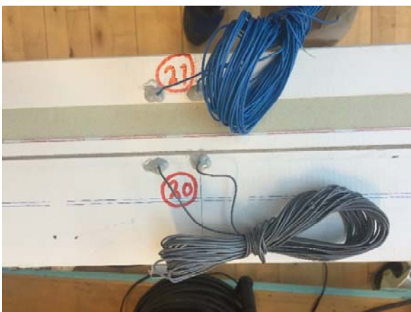
Billede 7: Eksempel på nummerering og placering af målepunkter på midt sidekarm vindue for kold og varm side
