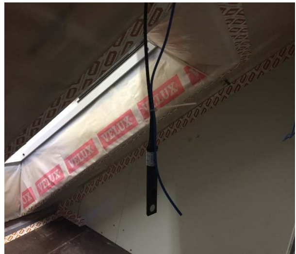
Billede 10: Forsøgsopstillingen set indefra med følere til temperatur/RF måling samt måling af tryk
