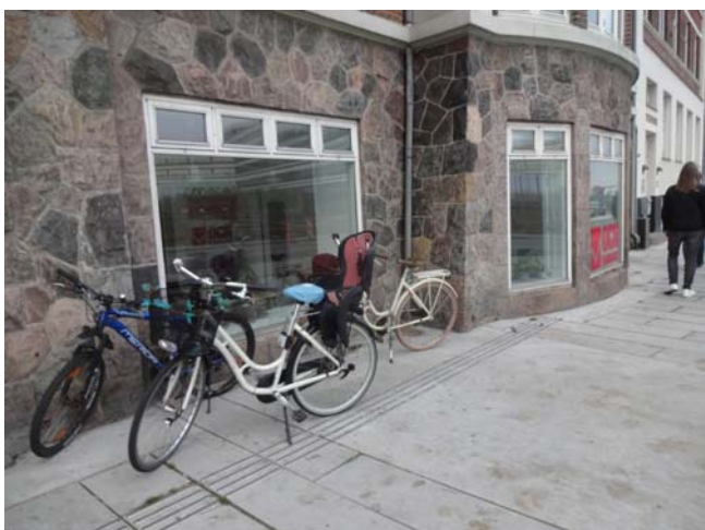
Figur 56: Kunstig ledelinje anvendt til afgrænsning af et areal, som med fordel kunne være markeret f.eks. med en chausséstensbelægning. Foto forfatteren.
