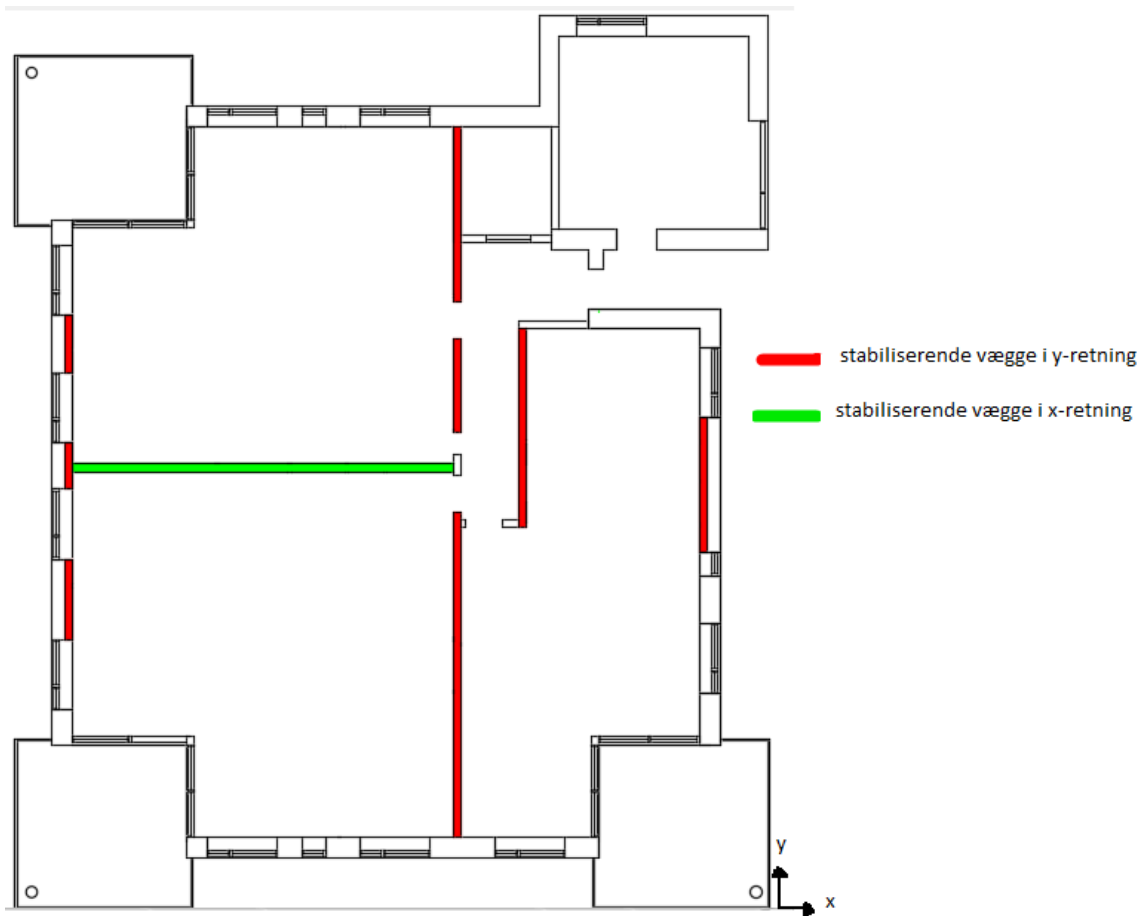
Figur 6.2 – Væggene der indgår i det stabiliserende system.
