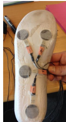
Figur 6: Placering af fodkontakterne på undersiden af højre slå.
