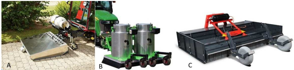
Figur 5 Maskinbårne fladebehandlere; A - Gasflamme fladebehandler for montering på minitraktor; B - Damp fladebehandler for traktor montering, af mærket FM S1 Ukrudtsdamper, diesel drevet; C - Infrarød-stråle fladebehandler for montering på traktor.
