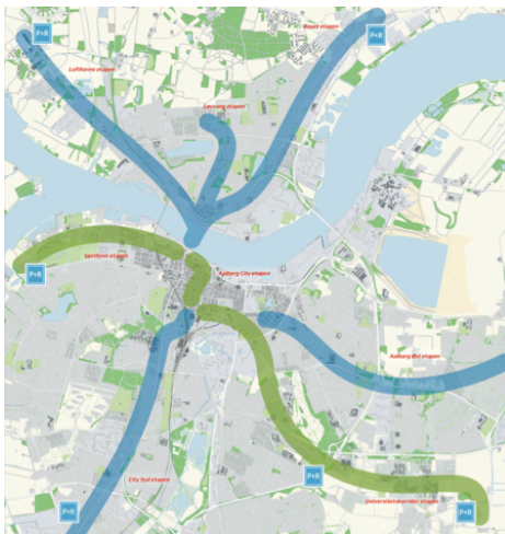
Figur 5.8: Den anbefalede linjeføring fra foranalysen (den grønne og de potentielle, fremtidige etaper (de blå). (COWI, 2013)
